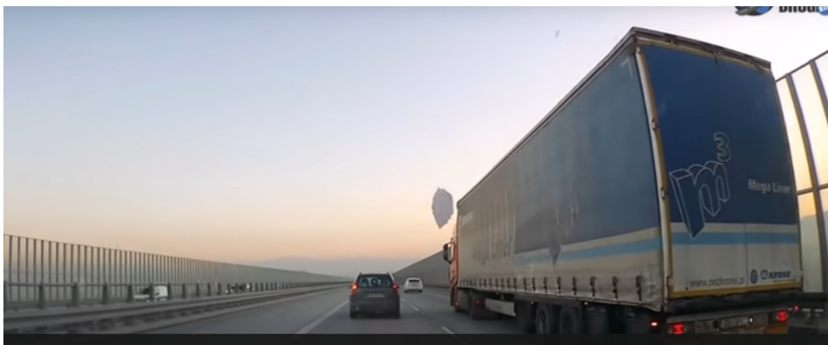
Fot.3. Nagły zrzut pokrywy śnieżno-lodowej z dachu pojazdu w trakcie manewru.
