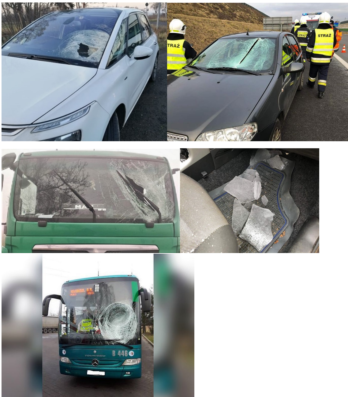
Fot.4. Uszkodzenia powstałe na skutek uderzenia lodu spadającego z innego pojazdu.
